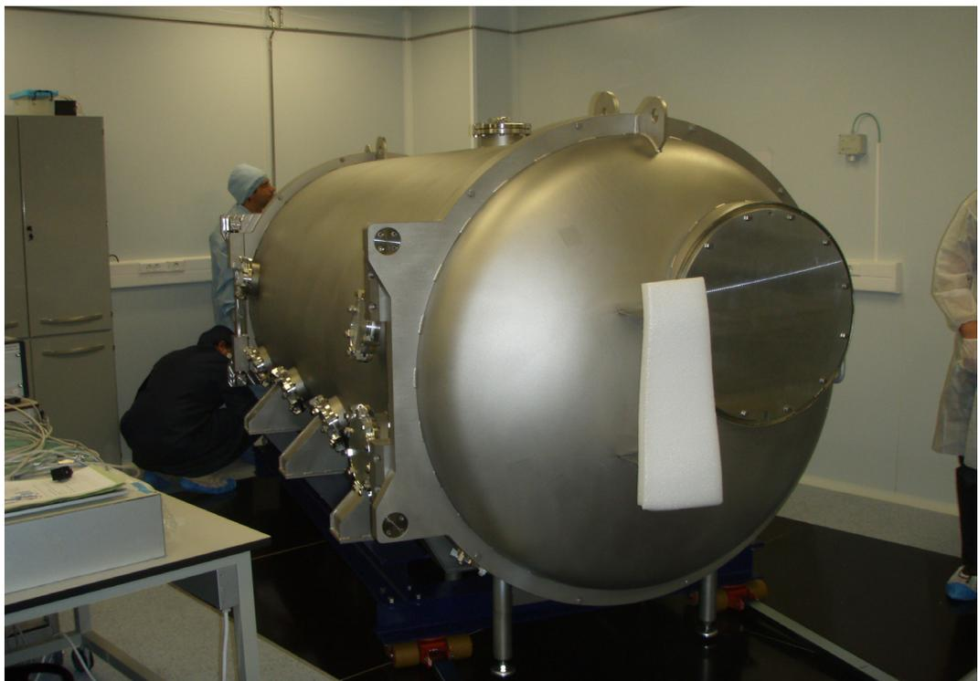
El tanque de vacío del canal NIR en las instalaciones del IAA.
