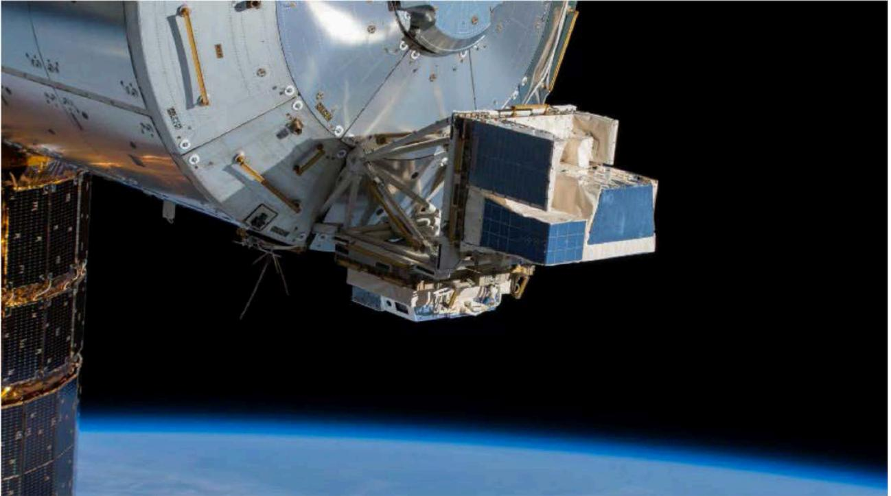
Figura 1. ASIM (apuntando a la atmósfera terrestre) en el centro de la imagen, adosado al módulo COLUMBUS de la Agencia Espacial Europea (ESA) de la *Estación Espacial Internacional*. Cortesía ESA.
