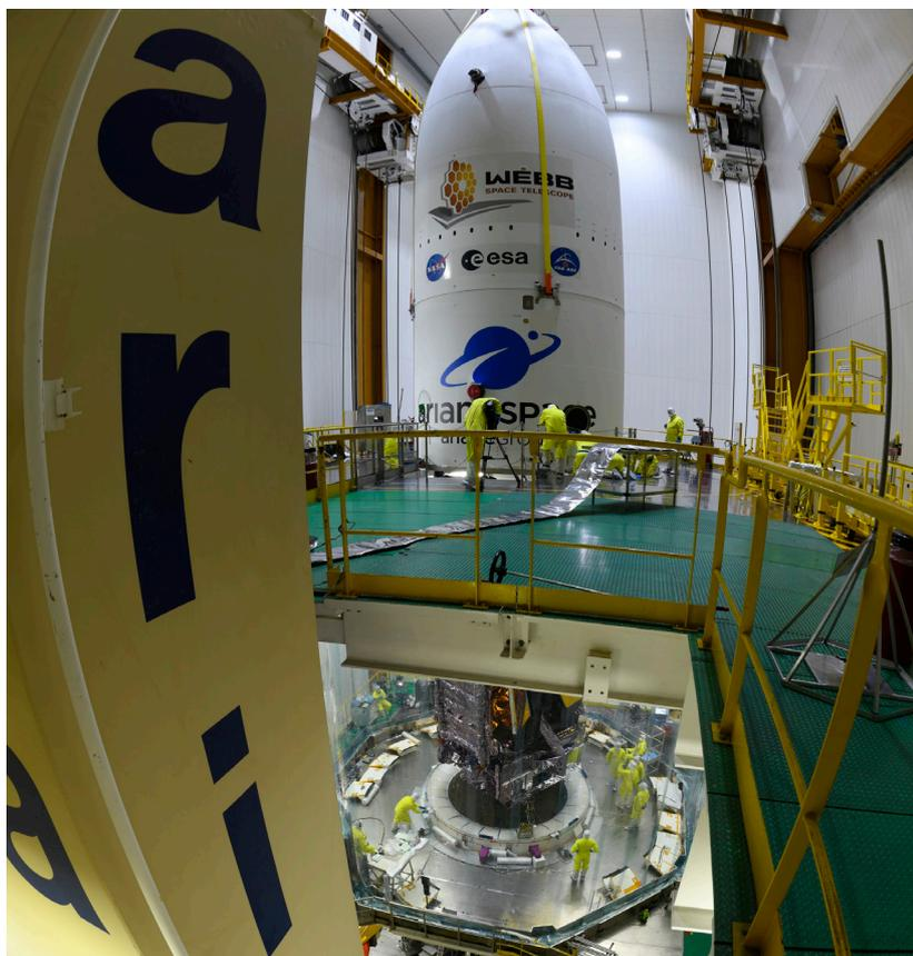
Figura 6. Esta fotografía captura el momento en el que Webb, en su configuración plegada en la parte inferior de la fotografía, es encapsulado en el carenado del cohete Ariane 5. Crédito: ESA/CNES/Arianespace
