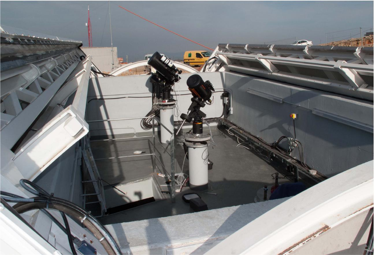
Vista del interior de la Cúpula de Monitores, con los monitores de *seeing* y extinción.
