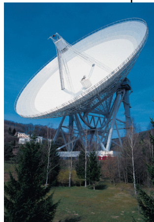
Fig. 4: O radiotelescopio de Effelsberg (Alemaña). Tamén a montura deste instrumento é altoacimutal. O casquete máis interno (de 60\text{m} de diámetro), que en ningún punto difire en máis de 0,6\text{mm} do paraboloide ideal, utilízase para as ondas milimétricas. A superficie completa utilízase para ondas comprendidas entre 6 e 92\text{cm} .
