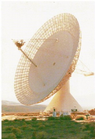
Fig. 1: o radiotelescopio de Owens Valley, en California. O paraboloide de 40m de diámetro, con montura altoacimutal, traballa con ondas comprendidas entre un centímetro e un metro.
