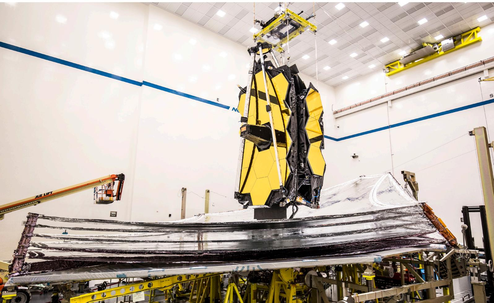
Figura 2. El telescopio Webb en Northrop Grumman, Redondo Beach, California. En esta imagen el parasol de 5 capas está completamente desplegado. Los espejos primario (18 segmentos hexagonales, 6.5 m) y secundario (espejo circular, 0.74 m) se muestran plegados y en la configuración de lanzamiento. Crédito: Northrop Grumman.
