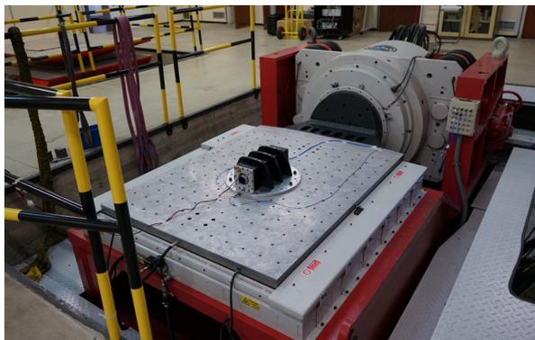
DRAGO antes del test de choque en CTA (arriba izquierda), el test de termovaciación en INTA (arriba derecha) y los ensayos de vibraciones en INTA (abajo izquierda).
