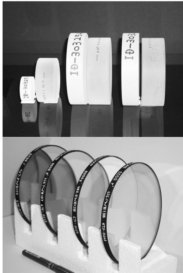
Figura 5: En la figura superior se muestran los substratos de las lentes de ELMER. En la inferior un conjunto de filtros de Sloan ya recibidos y listos para su instalación en ELMER.
