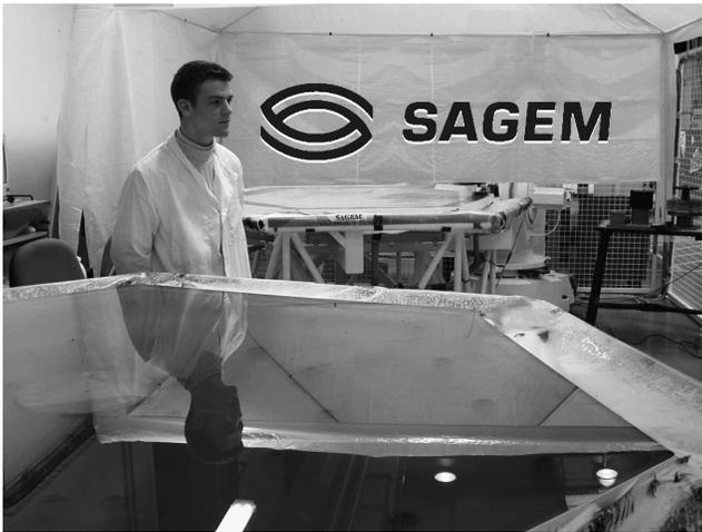
**Fig. 3.** El segmento 5/2 (Graja) una vez pasado el proceso de asferización y pulida su superficie a escala especular. A partir de ahora comienza para él el proceso de ajuste a la forma definitiva. Fotografía tomada en octubre de 2001 por gentileza de SAGEM.
