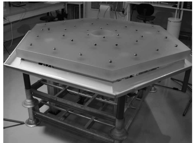
Fig. 4. Parte trasera de uno de los segmentos del primario con las almohadillas de enganche del árbol de palancas que transmite las fuerzas y momentos de los actuadores.
