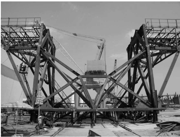
Fig. 2. La montura del telescopio en la fábrica de Tarra-gona, mostrando el suelo rotante, el yugo y las plataformas Nasmyth.
