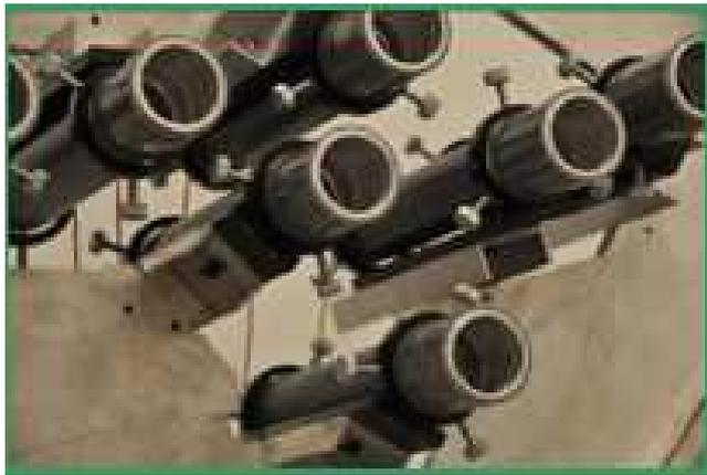
Figura 4 — *El simulador de telescopio que utilizará OSIRIS para sus pruebas ópticas. Los tubos que se aprecian en la figura sujetan cada uno una fibra óptica que se usa para simular puntos de luz en el plano focal del telescopio. La disposición de las fibras es tal que se ocupa todo el campo accesible a OSIRIS.*
