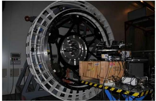
Figura 5 — *El simulador de telescopio montado en el rotador del Laboratorio de Integración del IAC.*
