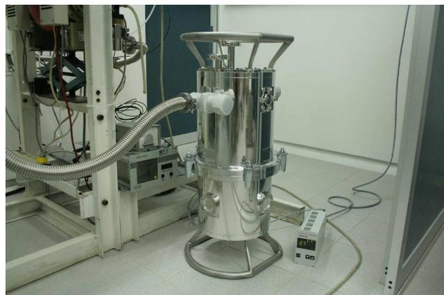
Figura 7 — El criostato de pruebas de FRIDA, llamado Colibrí, siendo enfriado en el laboratorio de la UNAM, México.
