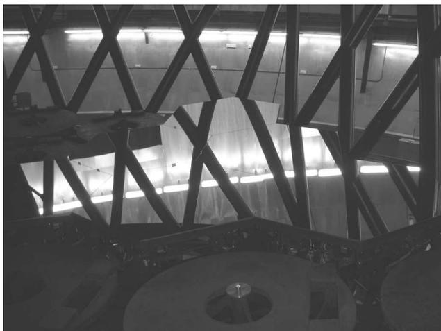
Figura 7 — Los seis segmentos del primer lote colocados en la celda del espejo primario.
