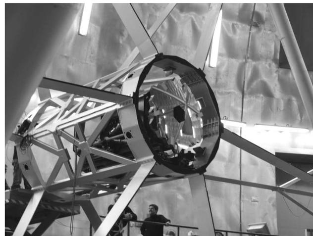
Figura 6 — El secundario en su jaula, en la parte superior del tubo. Detrás del espejo secundario pueden verse los mecanismos y el hexápodo que realizan los complicados movimientos de dicho espejo.
