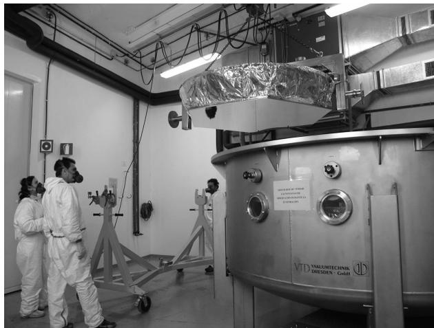
Figura 3 — Un segmento saliendo de la cámara de aluminizado. Nótese el papel de aluminio que hace de falda, para evitar que se deposite aluminio en las partes posteriores del segmento.
