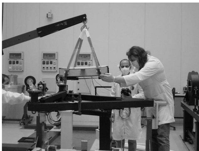
Figura 6 — El colimador de OSIRIS siendo integrado en su estructura de soporte
