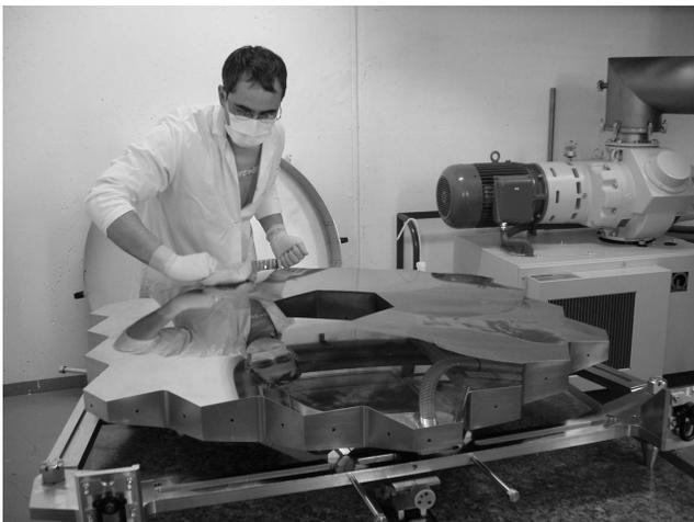
Figura 2 — El espejo secundario, ya en el observatorio, durante el proceso de aceptación. Nótese la forma serrada de este espejo, igual a la forma exterior del espejo primario. Recuerdo aquí que este espejo secundario es quien define la pupila de entrada del GTC, de ahí que la forma sea igual a la del primario.
