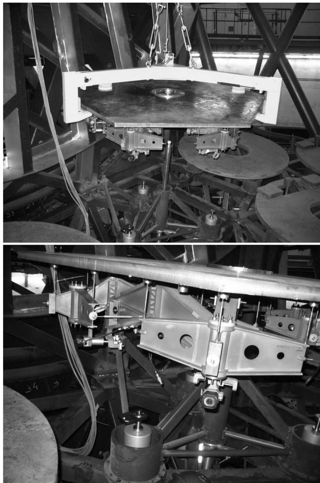
Figuras 7 y 8 — Pruebas de colocación de un segmento en la celda del primario. La figura 7 muestra la maqueta de un segmento provista de su árbol de levas, siendo bajada hasta su lugar en la celda del primario. La figura 8 muestra dicha maqueta ya introduciéndose mediante su guía en su lugar en la celda.
