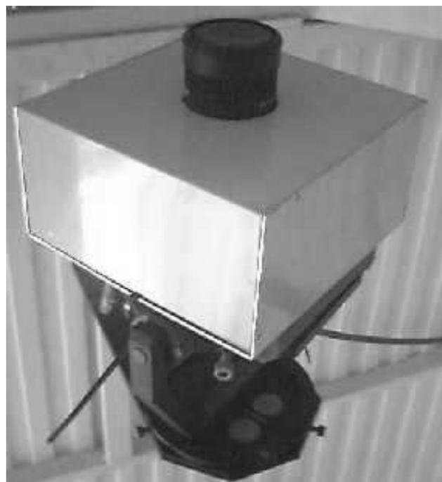
Figura 1 — La naturaleza compacta y ligera de la cámara CCD de todo el cielo aquí descrita permite su fácil instalación en una gran variedad de emplazamientos, como la situada originalmente en noviembre de 2002 en la estación astronómica donde se ubican los telescopios robóticos del Proyecto BOOTES en el Centro de Experimentación del Arenosillo del INTA.
