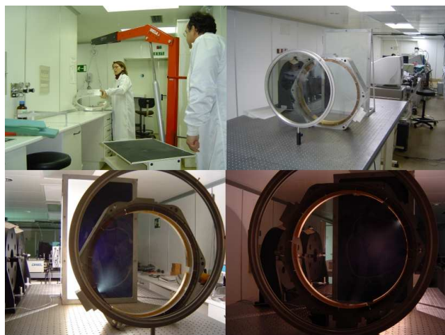
Figura 9 — Conjunto de imágenes de diversas pruebas de EMIR en el laboratorio de óptica probando la sujeción de grandes lentes. Arriba a la izquierda un prototipo de aro de sujeción de una lente grande, del tamaño de la ventana de EMIR. Abajo a la izquierda midiendo esfuerzo mediante el análisis de birrefringencia.
