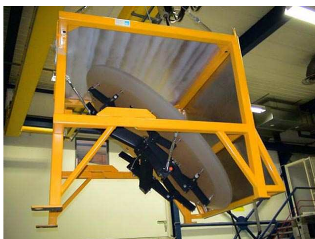
Figura 5 — Espejo terciario visto por detrás, en su útil de manipulación.
