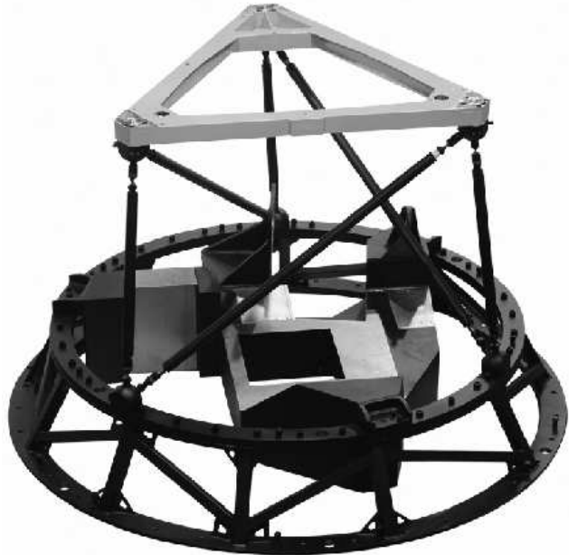
Figura 3 — Imagen de la estructura de OSIRIS ya terminada. Se acopla al foco Nasmyth, o Cassegrain, y se encarga de mantener todos los elementos de OSIRIS en su posición exacta y de conferir al instrumento la necesaria rigidez estructural.
