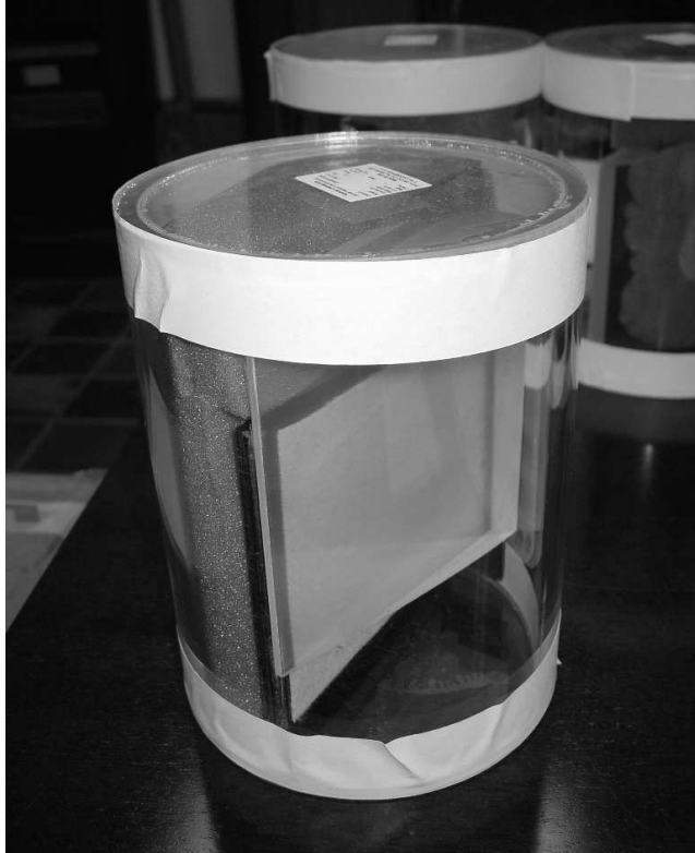
Figura 10 — El filtro sintonizable azul de OSIRIS en fase de caracterización en el laboratorio de óptica del IAC.
