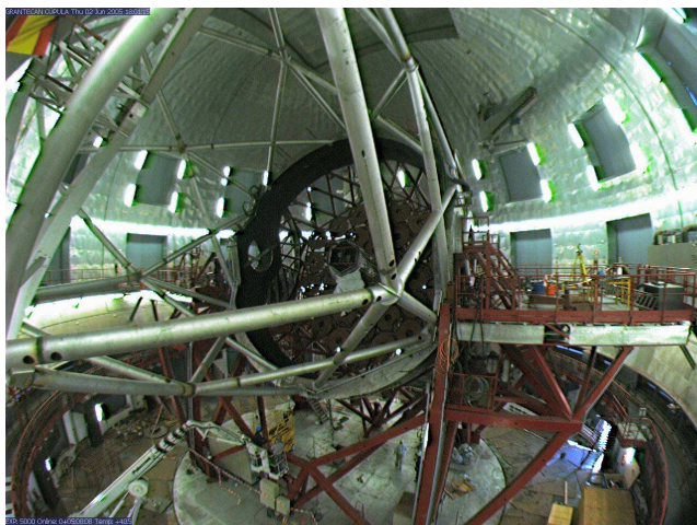
Figura 2 — El telescopio inclinándose para probar el sistema de aceite, y medir las deformaciones de los muñones.
