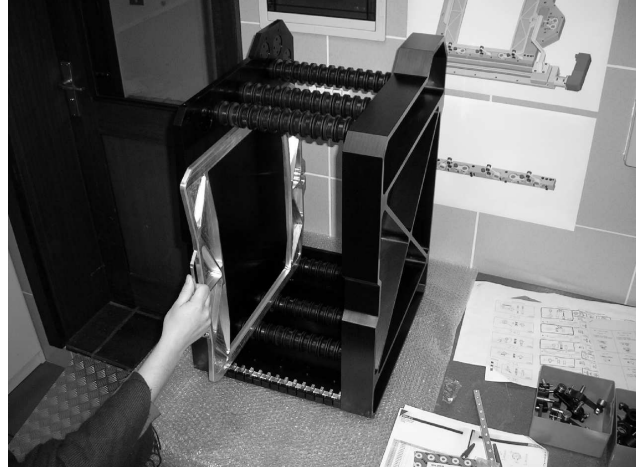
Figura 4 — Almacén de máscaras de OSIRIS ya terminado, con una de las máscaras multiobjeto sin anodizar. Tiene capacidad para 13 máscaras que se insertan o retiran del plano focal de OSIRIS en 12 segundos como máximo.
