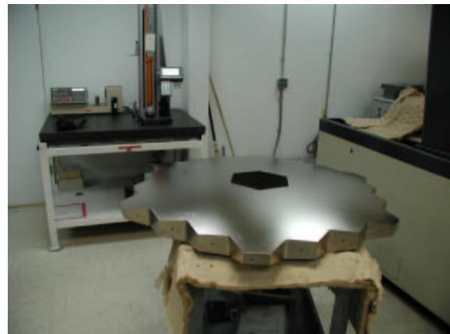
Fig. 3.: Substrato del secundario recubierto de níquel
