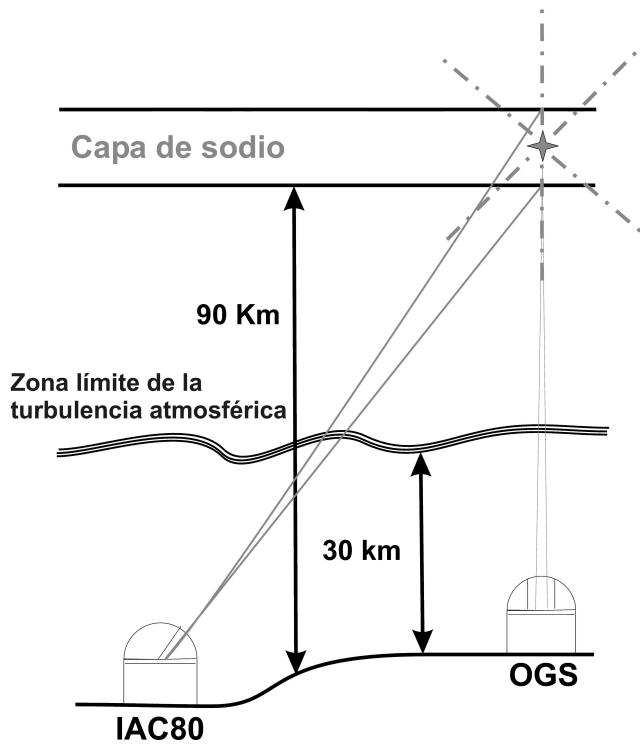
Fig. 3.: Diagrama de la configuración observacional del experimento CALAS. Lanzamos un láser en la longitud de onda de la transición  $D_2$  del sodio desde la OGS, observando el dispersión resonante desde el telescopio IAC80, situado a 165 metros, con lo que obtenemos información en altura de la distribución de sodio sobre el observatorio.
