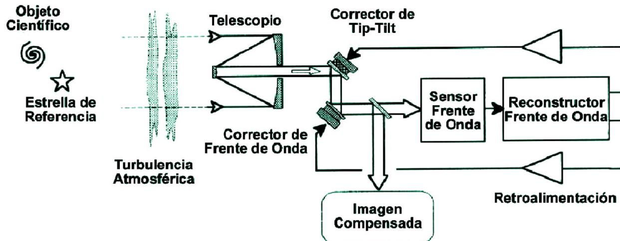
Fig. 1.: Diagrama conceptual de un sistema de óptica adaptativa
