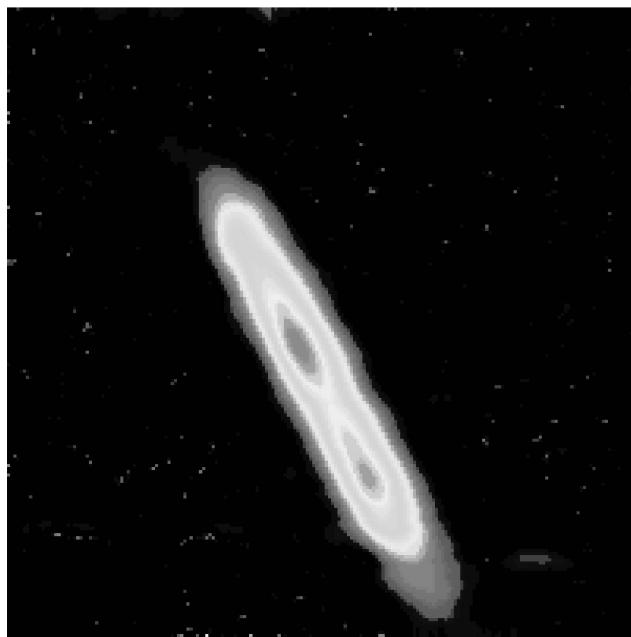
Fig. 2.: Imagen de una estrella de referencia en sodio generada en el Observatorio del Teide con el Experimento CALAS durante Diciembre de 2001. El haz láser excita resonantemente la transición  $D_2$  del átomo de sodio reemitiendo los fotones dispersados isotrópicamente y generando un objeto de referencia en las proximidades del objeto científico de interés.
