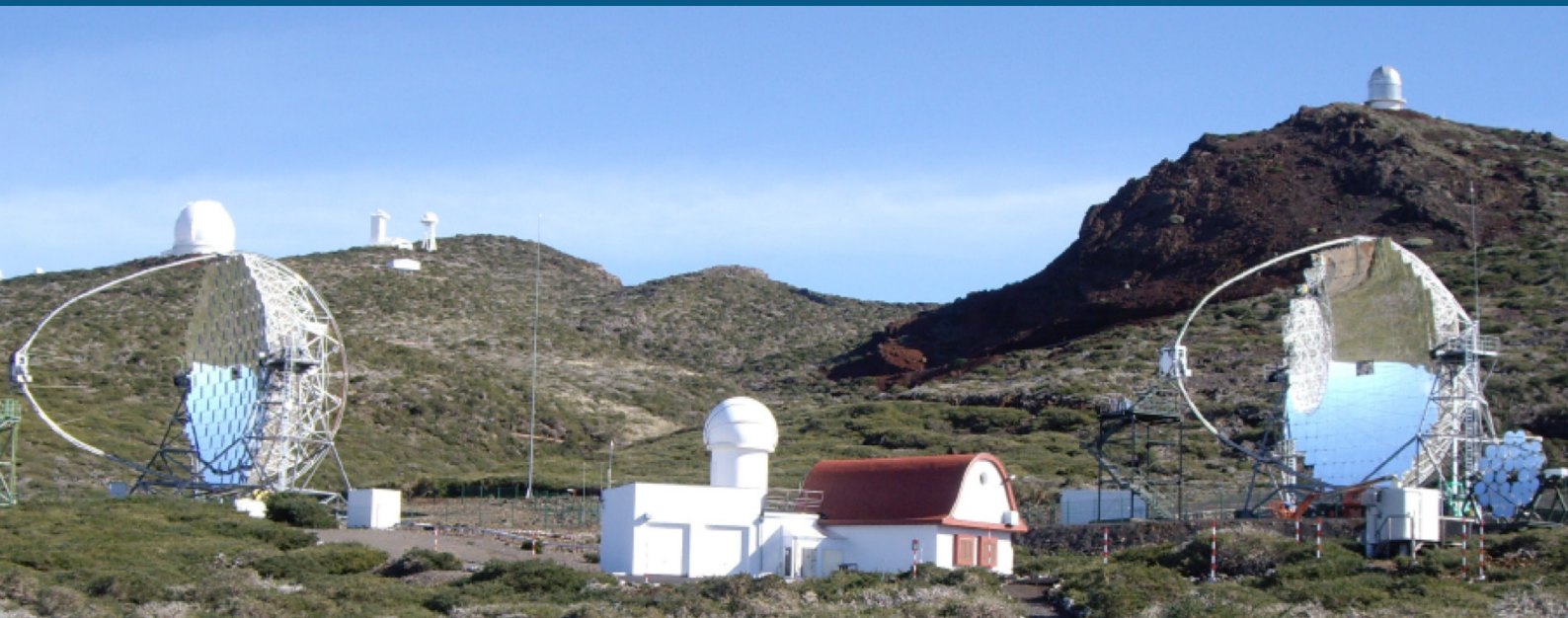
Figura 1. Telescopios MAGIC, de 17 m de diámetro, en el Observatorio Roque de los Muchachos. El edificio entre los dos telescopios es la casa de control, que contiene la electrónica para hacer el primer filtrado estereoscópico de los datos.
