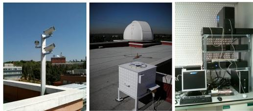
La SPMN está instalando por toda España cámaras de videodetección de meteoros y bólidos con la finalidad de estimar el origen en el Sistema Solar de las rocas que producen tales fenómenos luminosos.
