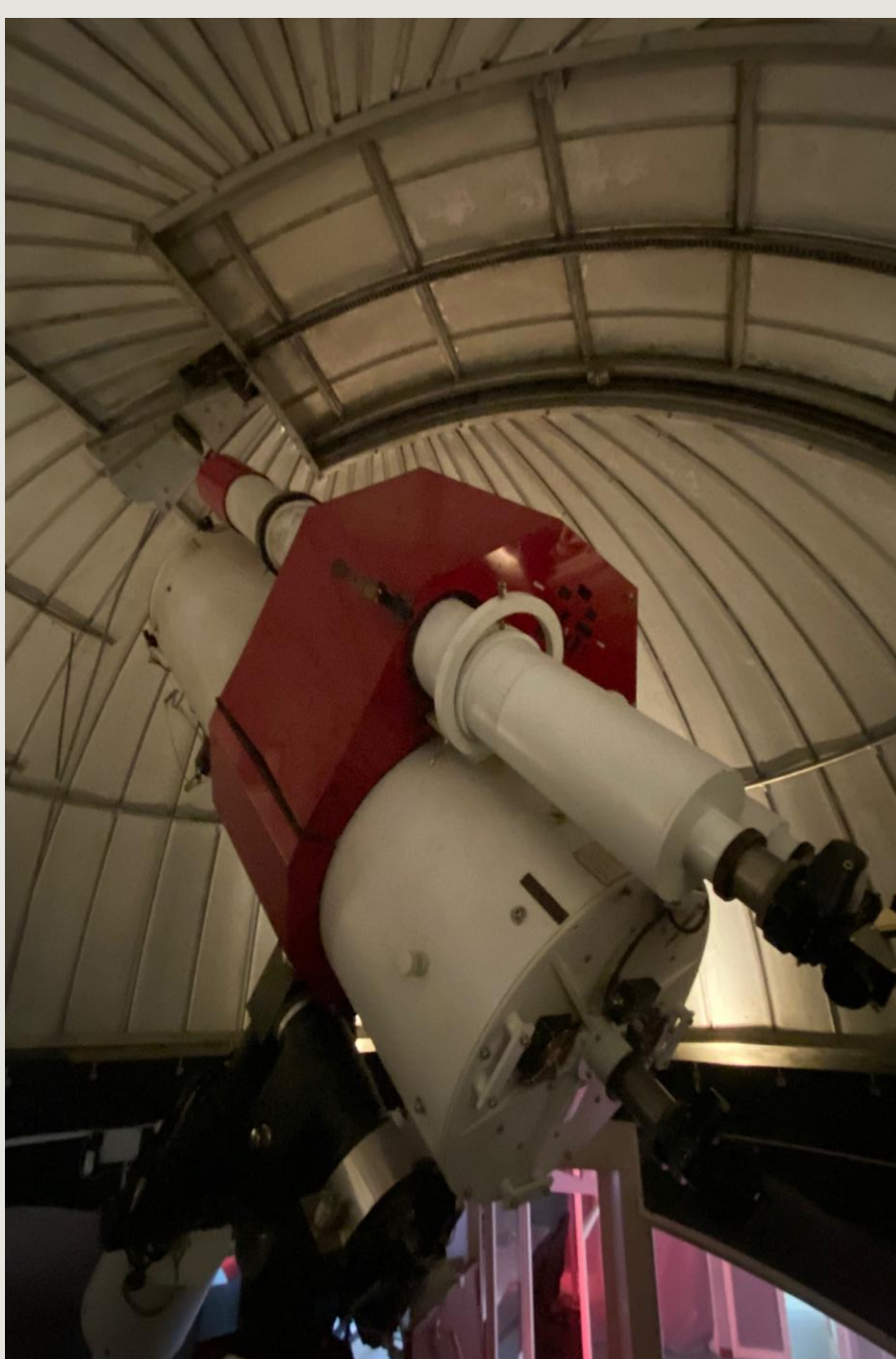
El objetivo, instalado en el guiado del telescopio de la Agrupación de Sabadell.
