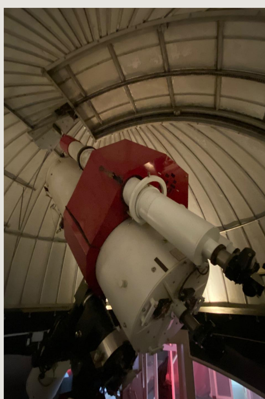
L'objectiu, instal·lat al guiatge del telescopi de l'Agrupació de Sabadell
