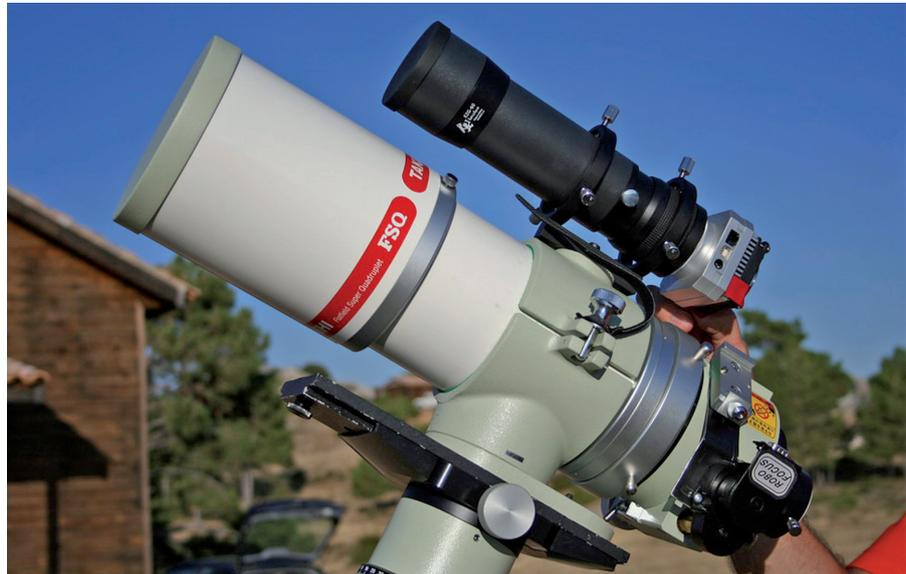
Telescopio guía con cámara CCD montado en paralelo sobre el telescopio principal. (Foto: Leonor Ana y Fernando Fonseca, [astronomadas.com](http://astronomadas.com))
