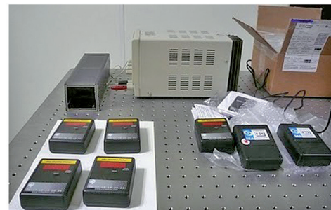
Figura 3. Montaje experimental para calibrar los fotómetros SQM en el laboratorio y carrusel para medir con todos ellos simultáneamente en el campo. El fotómetro SQM-LE montado en el centro obtiene datos continuamente y son almacenados en el ordenador para registrar variaciones de brillo durante las pruebas. (Fotos de Roque Ruiz y Jaime Zamorano)
