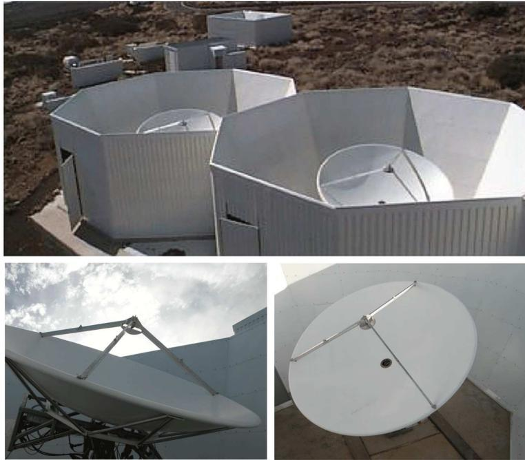
Figura 2.6: Sustractor de fuentes puntuales de VSA. La imagen superior muestra una vista general de este interferómetro de dos antenas, en la que se observan las pantallas laterales que lo protegen de la radiación procedente del suelo. La distancia entre las dos antenas es 9 m, y su diámetro 3 m. Las imágenes inferiores muestran una vista ampliada de una de las antenas.
